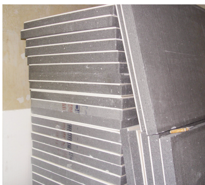
3 Verbundplatten aus Gipskarton (weiß) und Dämmplatten aus Neopor® (silbergrau).
